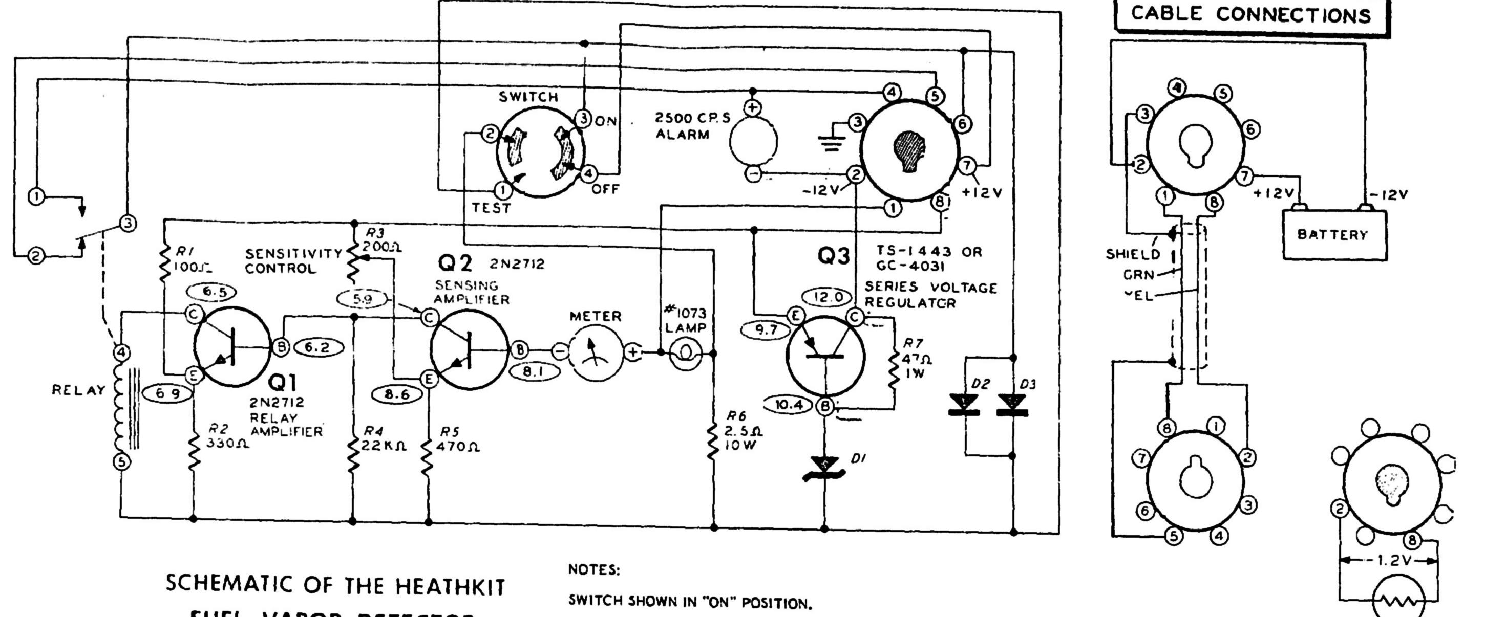
SCHEMATIC OF THE HEATHKIT FUEL VAPOR DETECTOR MODEL MI-25
